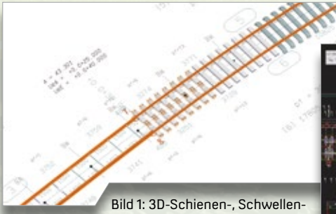
Bild 1: 3D-Schienen-, Schwellen- und Spurstangenteilung.
