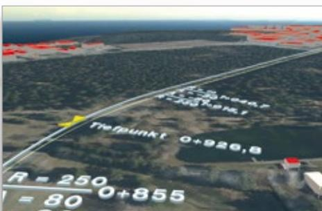
Bild 6: Hoch-/Tiefpunkte inkl. Beschriftung zusammen mit Achsbeschriftung in der 3D-Ansicht.
